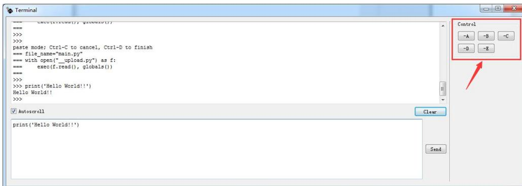
例如：在空命令行下，鼠标点击“-D”，即可对 ESP8266 进行软件复位，然后执行 ESP8266 中的程序代码。如果您的代码编辑有错误，在这里会有提示，告诉您那个文件的哪一行代码出错，然后中止程序的运行。
